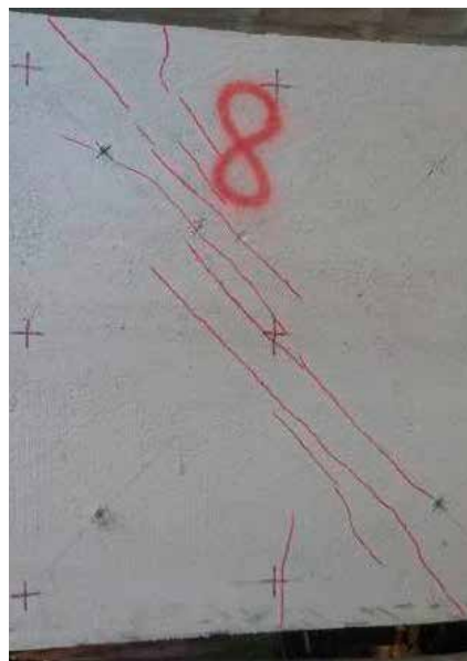
Modalità di rottura muro in tufo rinforzato con rete da 250 g/m 2 (a sinistra) con rete da 550 g/m 2 (a destra)
