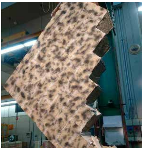
Modalità di rottura muro in tufo (sinistra) e in laterizio (destra) non rinforzati
