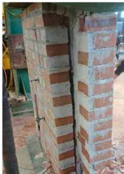
Modalità di rottura muro in mattoni pieni non rinforzato
