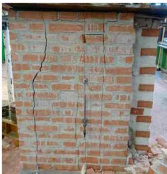
Modalità di rottura muro in mattoni pieni non rinforzato
