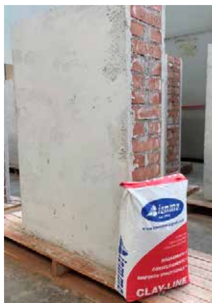
Realizzazione dei muretti e l'applicazione dei sistemi di rinforzo costituiti da rete bidirezionale in fibra di vetro Ar Glass e matrice inorganica a base calce idraulica.
