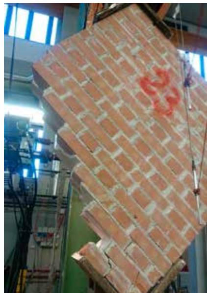
Modalità di rottura muro in tufo (sinistra) e in laterizio (destra) non rinforzati
