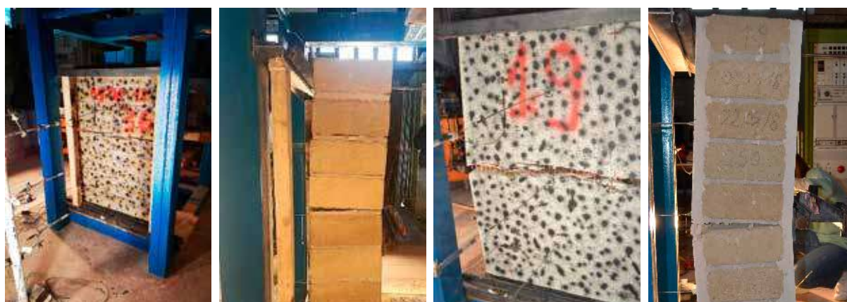
Modalità di rottura muro in tufo non rinforzato e rinforzato con rete da 250 g/m 2
