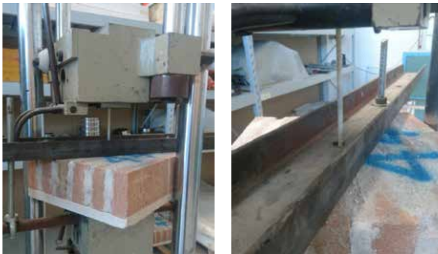
La macchina di trazione in controllo di spostamento
