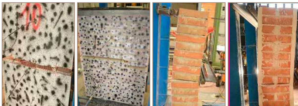
Modalità di rottura muro in mattoni pieni non rinforzato e rinforzato con rete da 250 g/m 2
