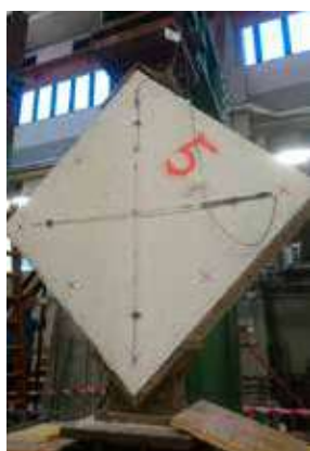
Prova di compressione diagonale: setup di prova, schema dimensioni muro e posizione connettori elicoidali in acciaio
