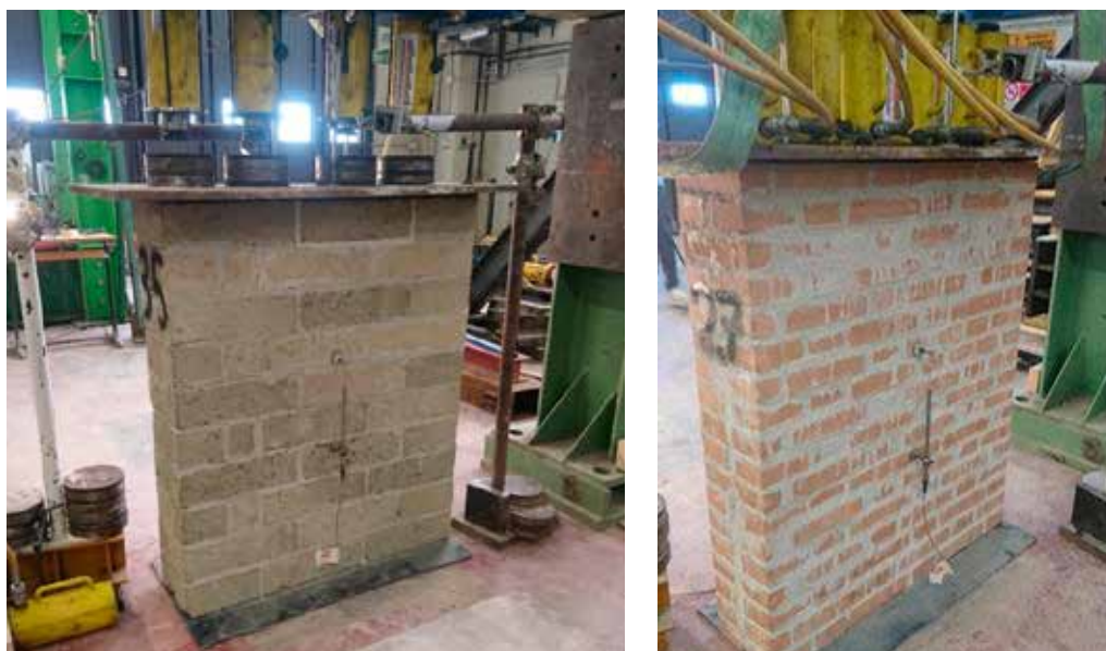
Prova di compressione semplice: setup di prova
