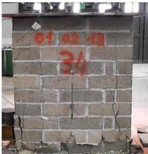
Modalità di rottura muro in tufo non rinforzato
