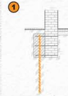
Μονόπλευρη στήριξη πεδילוδοκών για στερέωση τοιχωμάτων
